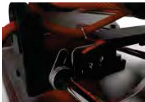
Il sistema comprende un interruttore di sicurezza che impedisce di filare la cima in assenza di tensione ed evita incattivimenti.
